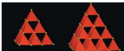
**Feuchteabhängige elektrische Leitfähigkeit**, mit Anwendungspotenzial in der Sensortechnik, liegt bei OCF-6GaSe vor, einem aus T3 ( $\text{Ga}_{10}\text{Se}_{20}^{10-}$ ) zusammengesetzten supratetraedrischen Galliumselenid mit offener Gerüststruktur (siehe Bild, links). Weiterhin wurden Materialien auf der Basis von T4 ( $\text{Zn}_4\text{Ga}_{16}\text{Se}_{35}^{14-}$ , rechts) erhalten, dem größten bislang bekannten supratetraedrischen Selenid-Cluster.
