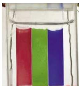
**RGB-Farbraum komplettiert:** Die elektrochemischen und optischen Eigenschaften des ersten elektrochemisch hergestellten leitfähigen Polymers, das in seiner Neutralform grün ist, werden beschrieben. Seine außerordentlich hohe Stabilität ist ein entscheidender Schritt vorwärts auf dem Gebiet elektrochromer Polymere, da dieses Polymer entsprechende rote und blaue leitfähige Polymere ergänzt (siehe Bild).
